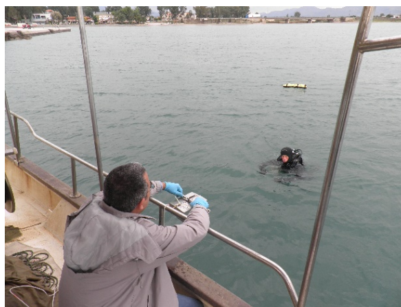
Διαδικασία ανέλκυσης δειγματολήπτη Van Veen που έχει συλλέξει ιζημα θαλασσίου πυθμένα από το αλιευτικό καταφύγιο Νέας Κίου. 2015 (Αναθέτων Φορέας: Δημοτικό Λιμενικό Ταμείο Ναυπλίου).
