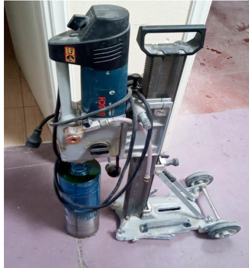
Μηχανή λήψης πυρήνων σκυροδέματος.
