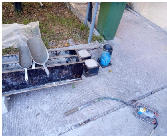
Παρασκευασθείσες δοκοί Οπλ. Σκυροδ.
