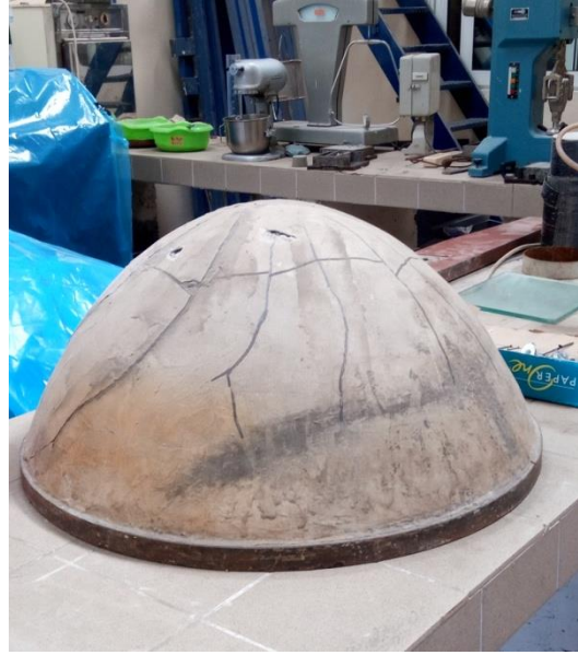
Θόλος τσιμεντοκονιάματος μετά από θραύση.
